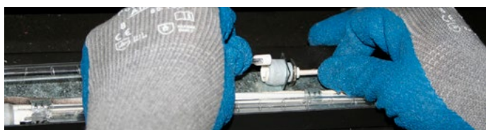
Figure 29.b Portez des gants lorsque vous manipulez les ampoules. Pour enlever une ampoule, tirez sur les câbles connectés des ampoules et tirez les ampoules vers le haut. Remplacez-les par les nouvelles ampoules.
