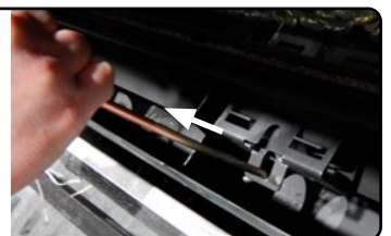
Figure 21.d Tirer les loquets de porte
