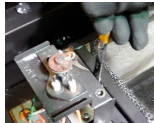
Figure 13.c Retrait de l'orifice
