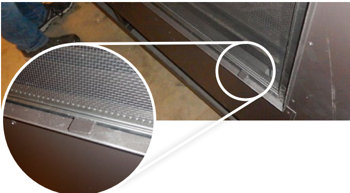
Figure 20. Localisez les trois onglets à la base de l'écran
