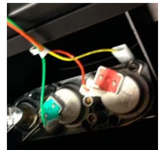
Figure 24.k Fils de valve
