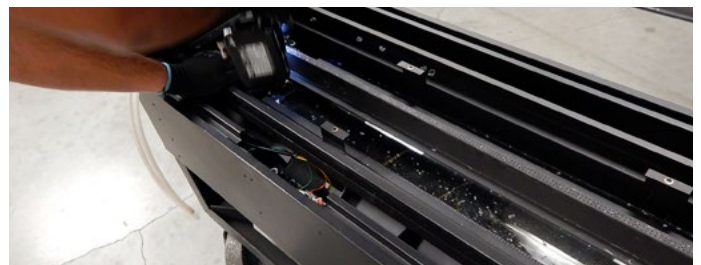
Figure 25.e Insérer le brûleur
