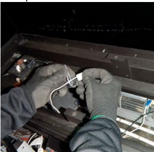
Figure 24.h Fil de ventilateur
