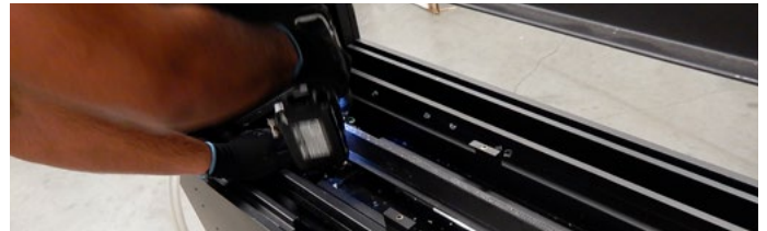
Figure 13. Enlèvement de la bande de brûleur
