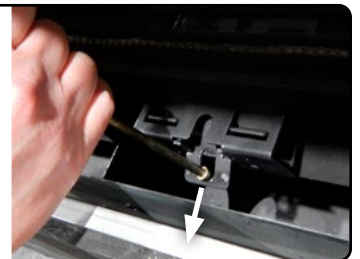
Figure 21.d Tirer les loquets de porte
