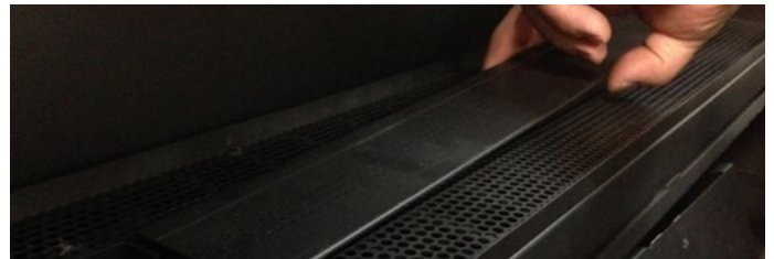
Figure 13.b Déserrer le venturi
