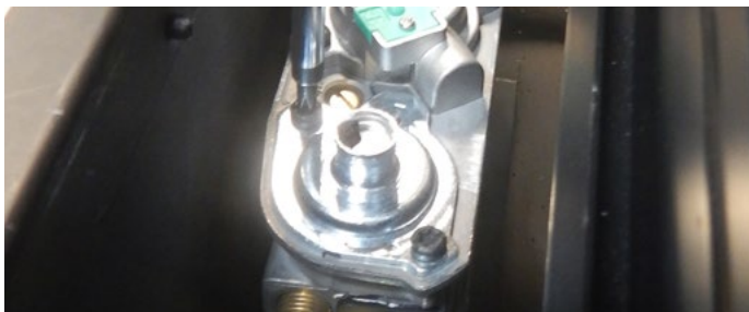
Figure 13.f Insérer l'obturateur pour gaz propane, puis remonter le brûleur
