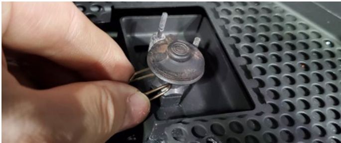
Figure 13.d Retrait de la sauterelle de fixation
