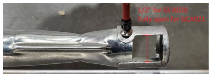
Figure 13.c Organe de réglage de la prise d'air principale
