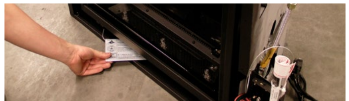
Figure 1.2 Emplacement de la plaque signalétique
