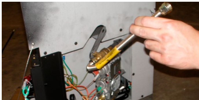
Figure 4.3 Conversion du régulateur de gaz au niveau de la soupape
